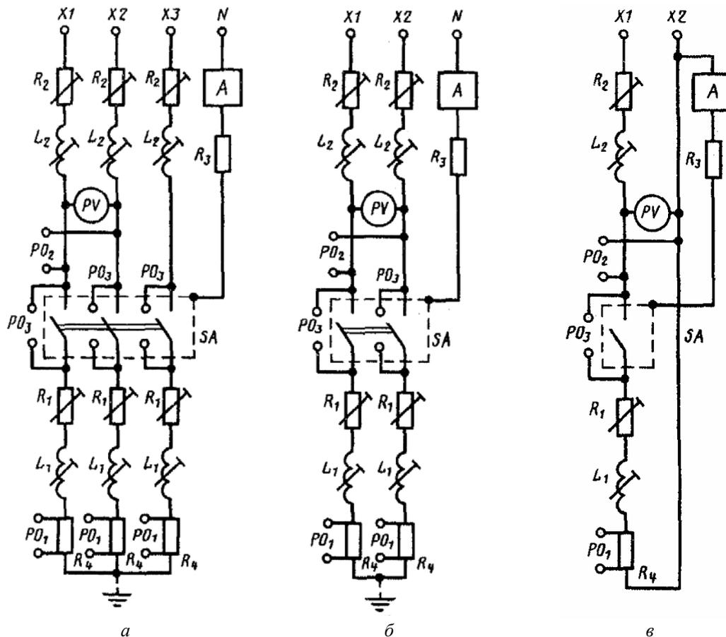
$X1, X2, X3$  — клеммы источника питания;  $N$  — нейтральная точка источника питания;  $PV$  — вольтметр;  $R_1, R_2$  — регулируемые резисторы;  $L_1, L_2$  — регулируемые катушки индуктивности;  $R_3$  — резистор для ограничения тока в устройстве  $A$ ;  $R_4$  — шунт;  $A$  — устройство для обнаружения перекрытий дуги;  $SA$  — испытуемый аппарат;  $PO_1$  — осциллограф для записи тока;  $PO_2, PO_3$  — осциллографы для записи напряжения
