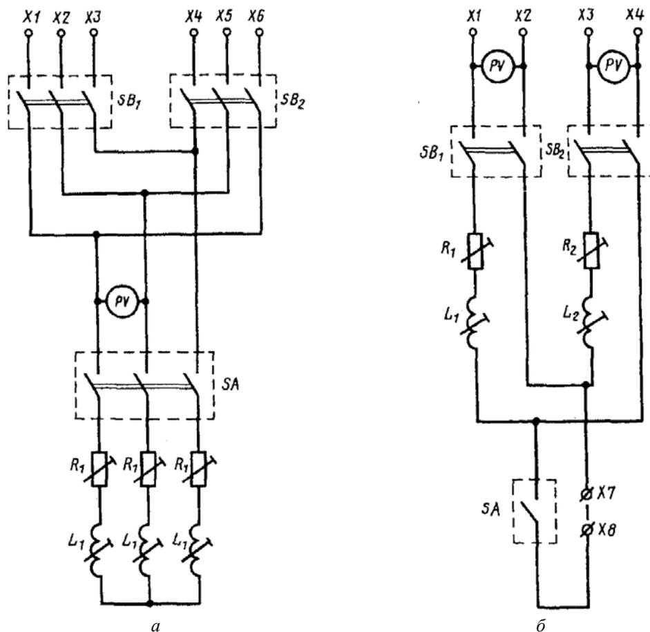
$X1, X2, X3, X4, X5, X6$  — клеммы источников питания;  $R_1, R_2$  — регулируемые резисторы;
