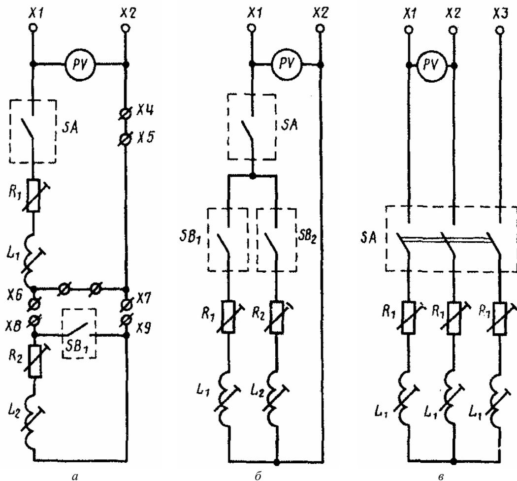
$X1, X2, X3$  — клеммы источника питания;  $R_1, R_2$  — регулируемые резисторы;
