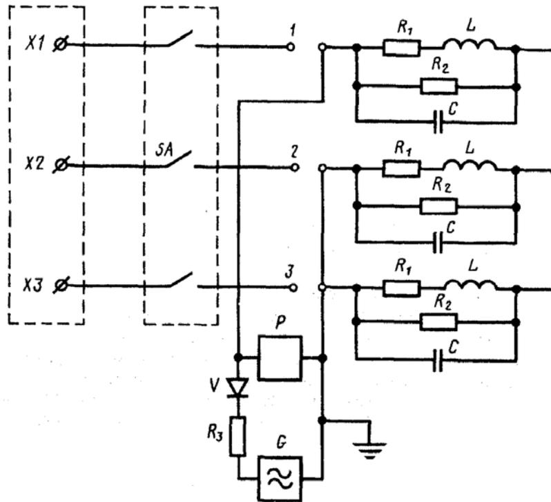
$X1, X2, X3$  — клеммы источника питания;  $SA$  — испытуемый аппарат;
