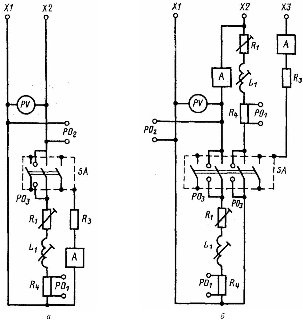
*X1, X2, X3* — клеммы источника питания; *PV* — вольтметр; *R1* — регулируемый резистор; *L1* — регулируемые катушки индуктивности; *R3* — резистор для ограничения тока в устройстве *A*; *A* — устройство для обнаружения перекрытий дуги; *SA* — испытуемый аппарат; *PO1* — осциллограф для записи тока; *PO2, PO3* — осциллографы для записи напряжения; *R4* — шунт
